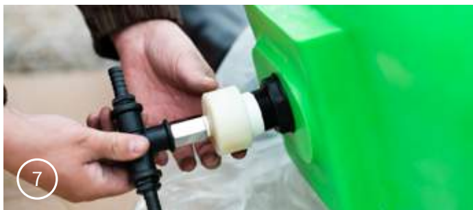
7 Tekerjük/csavarjuk fel a leeresztő egységet a csomkra, lehetőleg ütközésig.
