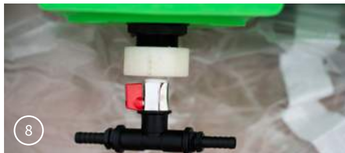
8 Készre szerelt 200 literes leeresztő egység.
