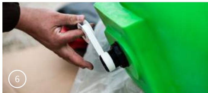
6 A 200 literes tartály leeresztő csomkjára a jobb tömítettség érdekében használjunk teflonszalagot.
