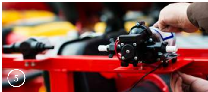
5 Szivattyú rögzítése a tartóhoz.
