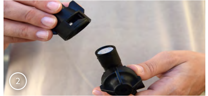
2 A szórófejtartó aljáról vegyük le a bajonettzárat.
