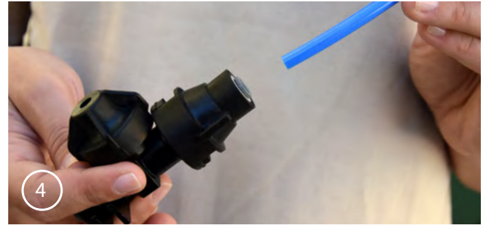
4 A műanyag csövet felülről a szórófej tartóhoz csatlakoztatjuk.
